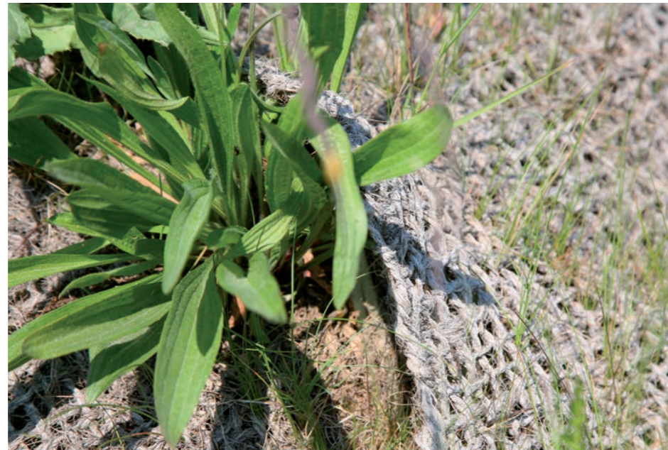
Jutegewebe im Bewitterungsversuch
