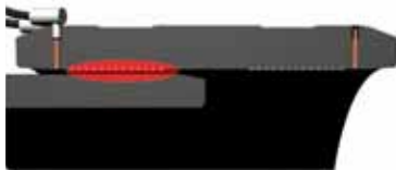
Abb. 38 – Querschnitt einer bifilaren Heizwendelschweißung
