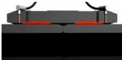
Abb. 37 – Querschnitt einer monofilaren Heizwendelschweißung
