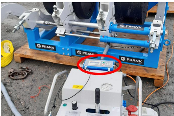
Abbildung 3: Links: Widos 8000 mit speziell angefertigtem Protokollaufzeichnungsgerät
